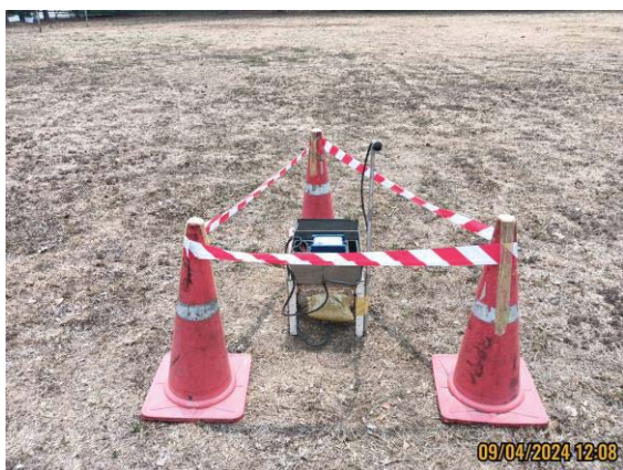
รูปที่ 4.3-15 แสดงการตรวจวัดความสั่นสะเทือน บริเวณโรงโมหินของโครงการ
